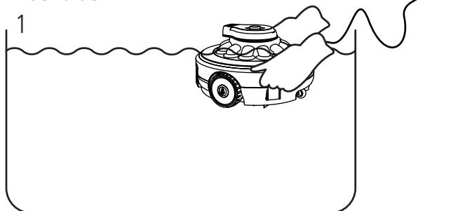
1. Pulse el interruptor, suelte la cuerda del flotador, coloque el robot en posición horizontal dentro de la piscina y espere a que se sumerja por sí mismo hasta el fondo. (Si el dispositivo no se introduce en el agua, la máquina no rota porque cuenta con una función específica de detención si no está en el agua).
