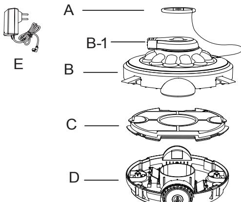
Na pokrywie górnej znajduje się obrotowa głowica strumieniowa, która wyrzuca wodę zasysaną spod odkurzacza – odrzut strugi wody z głowicy powoduje, że odkurzacz porusza się. Gdy odkurzacz dojedzie do przeszkody, głowica obraca się o 180 stopni, przez co urządzenie zmienia kierunek ruchu, omijając przeszkodę. Odkurzacz zasysa i zbiera zanieczyszczenia od dołu obudowy, wciągając je do komory filtra workowego.
