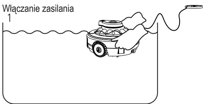
Włącz zasilanie przełącznikiem, wybierz linkę z pływaka, po czym włóż odkurzacz poziomo do wody – pozwól mu swobodnie opaść na dno. (Odkurzacz nie włącza się poza wodą – ma funkcję automatycznego wyłączenia się po wyjęciu z wody.)
