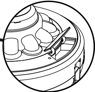
Open dit klepje, zo kunt u de robot eenvoudig oppakken en dragen.
