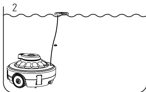
Ajuste o comprimento da corda para se assegurar de que esta está à altura do nível da água, e ate ou corte a corda sobrante.
