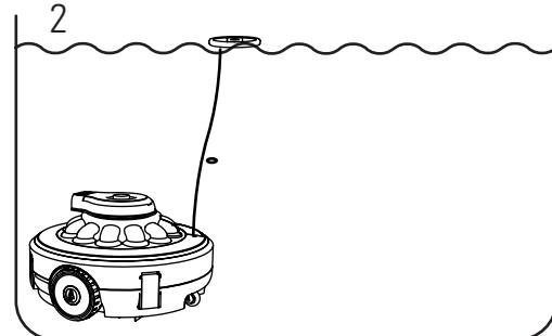
Passen Sie die Seillänge an die Höhe des Wassersstands an. Das übrige Seil können Sie festbinden oder abschneiden.
