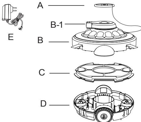
Er zit een roterende straalkop aan de bovenklep, het water stroomt van de onderkant naar de straalkop om de robot in beweging te brengen. Als hij naar een obstakel tegenkomt, draait de straalkop 180 graden en beweegt de robot langs een andere lijn rond het obstakel. Het vuil wordt verzameld en opgeslagen doorn de onderste filterkamer.
