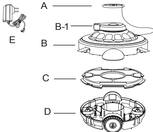
An der oberen Abdeckung befindet sich ein Düsenkopf.
