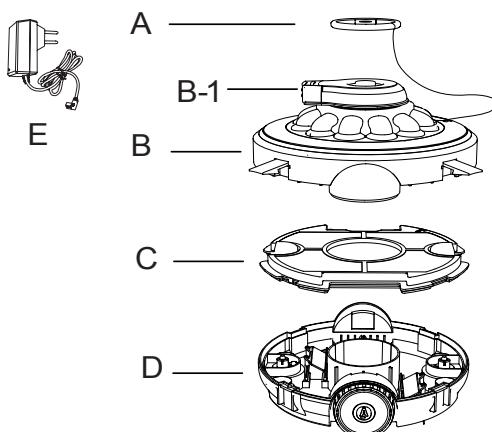
A cabeça de jato está situada na tampa superior. A água passa da parte inferior à cabeça, para que o robô avance. Ao encontrar um obstáculo, a cabeça gira 180°, fazendo o robô esquivar o obstáculo deslocando-se por outra linha. O filtro inferior recolhe e armazena os detritos num recipiente.
