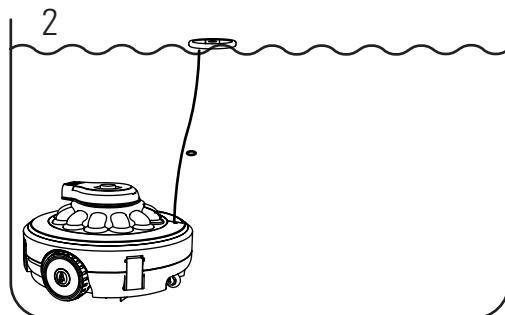
Zet de schakelaar aan, maak het touw aan de drijver los, plaats de robot horizontaal in het zwembad en wacht tot de robot vrij naar de bodem zakt. (als het apparaat niet in het water wordt geplaatst, zal de motor niet draaien omdat het is voorzien van de functie «stoppen buiten het water»).
