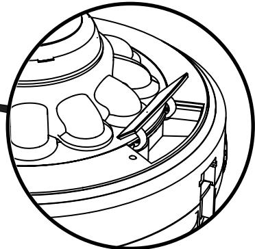
Aprire questo alloggio manualmente ed estrarre facilmente il robot
