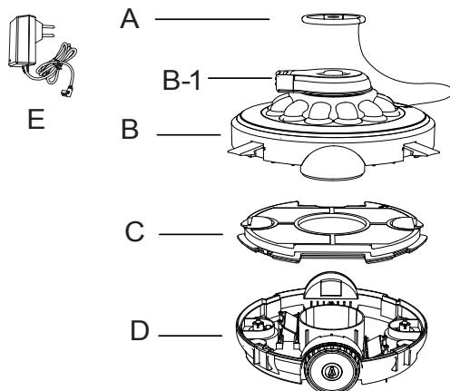
La tête de jet est située sur le couvercle supérieur. L'eau passe depuis la partie inférieure jusqu'à la tête pour que le robot avance. Face à un obstacle, la tête tourne de 180°, ce qui permet au robot de l'éviter et de se déplacer sur une autre ligne. Le filtre inférieur collecte et stocke les déchets dans un récipient.
