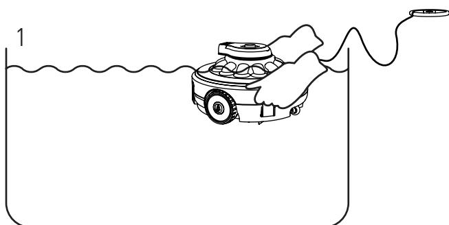
Prima o interruptor, solte a corda do flutuador, coloque o robô na posição horizontal dentro da piscina e espere que este se submerja por si mesmo até ao fundo. (Se o dispositivo não se introduz na água, a máquina não girará, porque incorpora uma função específica de paragem se estiver fora da água).
