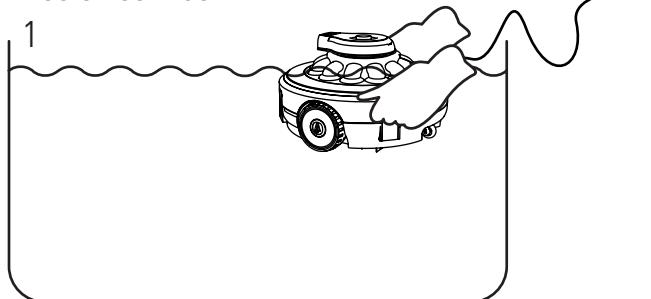
Appuyez sur l'interrupteur, lâchez la corde du flotteur, placez le robot en position horizontale dans la piscine et attendez que ce dernier atteigne seul le fond du bassin (si le dispositif n'est pas introduit dans l'eau, la machine ne tourne pas, étant donné qu'elle possède une fonction spécifique d'arrêt si elle n'est pas immergée dans l'eau).
